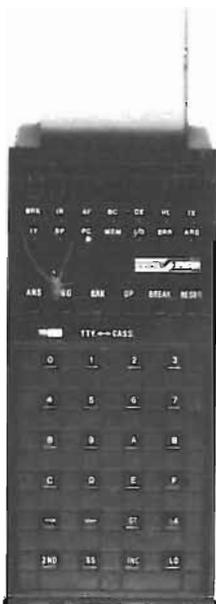
*L'unità di controllo (tastiera + display) del Nanocomputer NBZ80 della SGS-ATES.*
